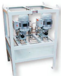
UNIDADE DE INJEÇÃO DE PRODUTOS QUÍMICOS Fluido: Inibidor de Corrosão. 2 bombas. Pressão: 1.160 psi. Vazão: 4,5 l/h.
