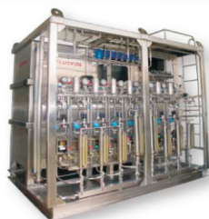
Unidade de Injeção Química Fluido: Inibidor de Hidratos. Pressão 5.600 psi. Vazão 50 l/h. 8 bombas. Ajuste de dosagem manual.
