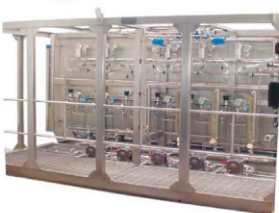
Unidade de Injeção Química Fluido: Inibidor de Corrosão. Pressão: 1.500 psi. Vazão: 50 l/h. 6 bombas. Ajuste de dosagem manual.
