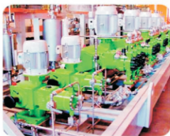
UNIDADE DE INJEÇÃO DE PRODUTOS QUÍMICOS. 10 bombas e motores.
